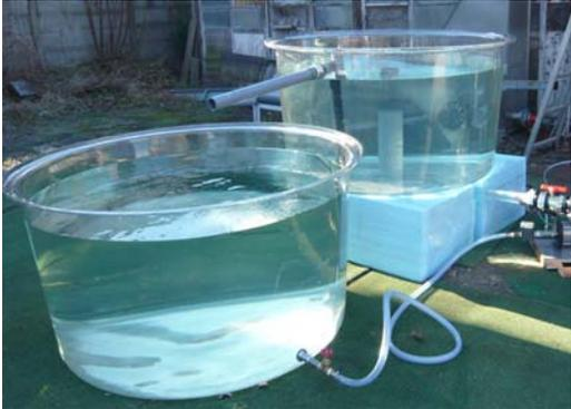
二相流旋回方式(高濃度タイプ)を油分回収用に調整
