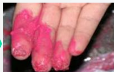
写真4：塗料スラッジの性状変化（水で簡単に落ちる）
