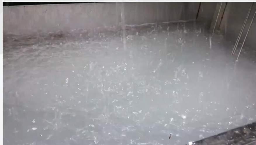
▲ 设备中微气泡水与废气混合气旋情况
